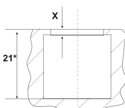
x - grubość czołowej płyty montażowej /толщина фронтальной монтажной плиты
